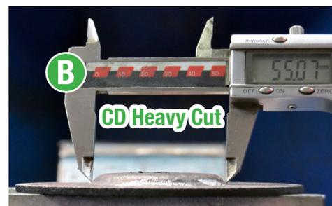
Misurazione cupole di 2 dischi da  $\phi$  115 mm: **CD standard (A)** e **CD Heavy Cut a "cupola stretta" (B)**.
